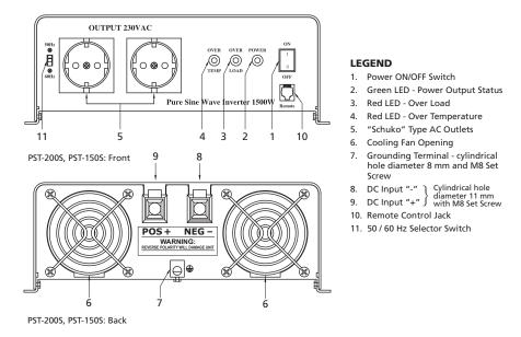
Fig. 6.3: Layout of PST-150S-12E, PST--150S-24E, PST-200S-12E, PST--200S-24E
