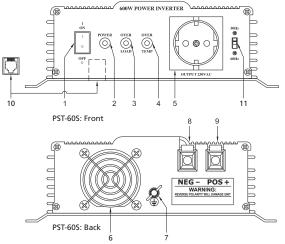
Fig. 6.1: Layout of PST-60S-12E, PST-60S-24E
