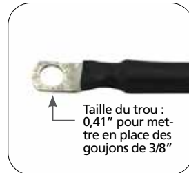
Fig. 3,14. Terminaison câble négatif
