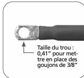
Fig. 3,13. Terminaison câble positif
